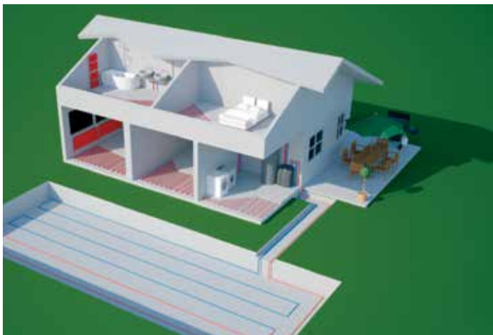
Horizontalni - zemeljski kolektor
